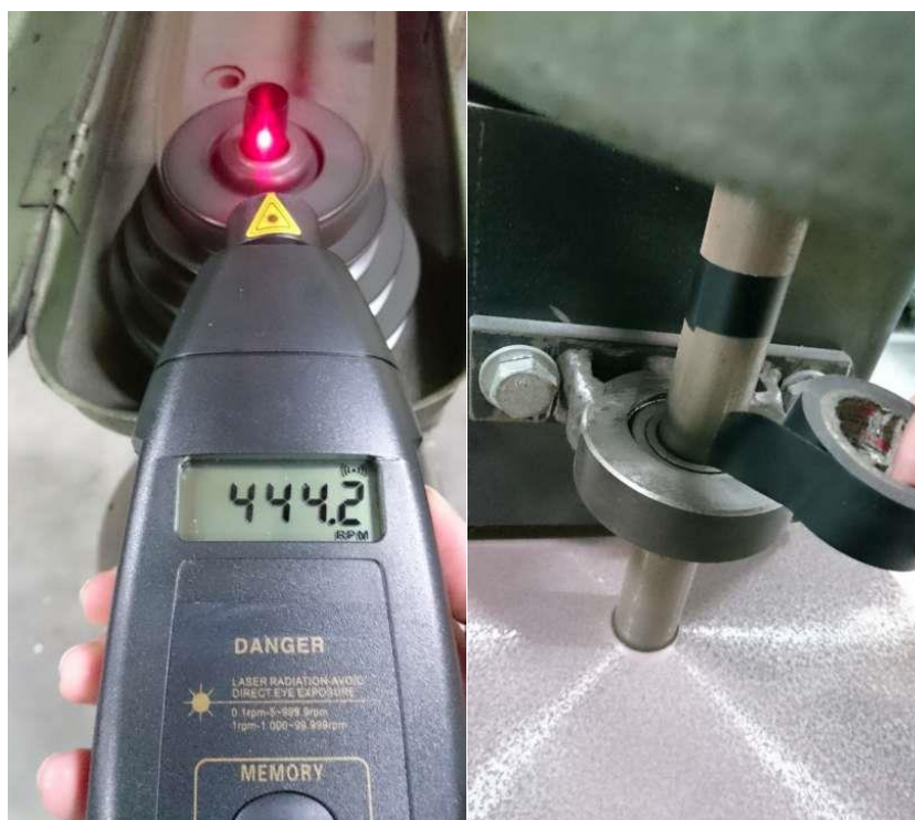
圖 17 轉速計及測量前準備
