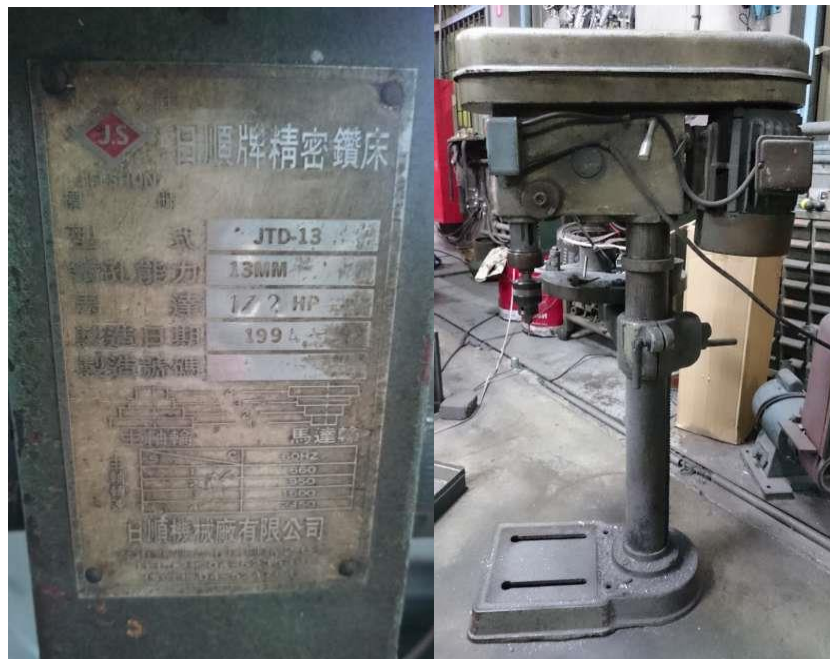
圖 9 鑽床原貌及其型號說明
